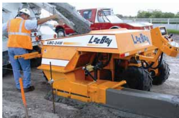
>>> Небольшая масса (3175 кг), привод на все колеса и высокая маневренность упрощают настройку и транспортировку машины LeeBoy LBC-24W
